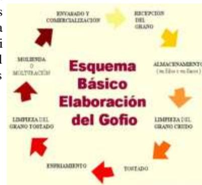
Figura 2. Esquema del proceso de elaboración del gofio.
